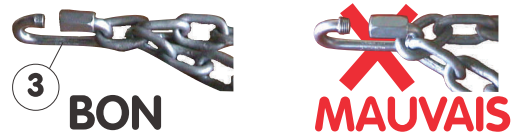
Figure 6 & 7 - Montage maillon rapide (3) / chaîne
